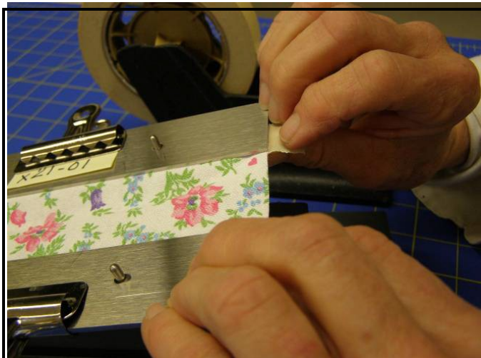
图 9. 可以用胶带进一步固定样本。
