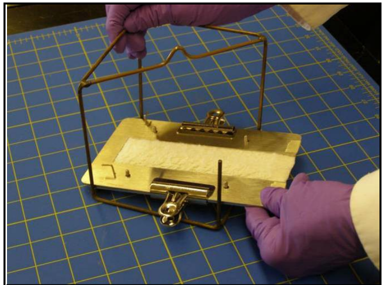
图 13. 将刷过的样本放在样本架上。
