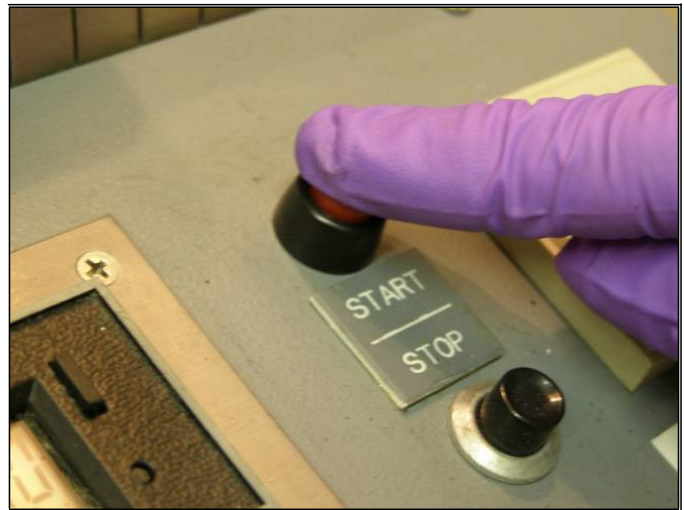
图 26. 启动触发装置。
