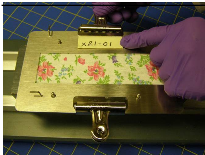
图 8. 将样本固定在样本夹上。
