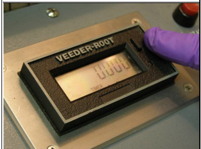
图 25. 将计时器设定为零。
