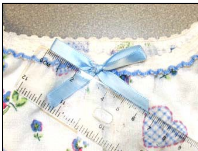
图 53. 检验最长部分大于 5.18 厘米的镶边
