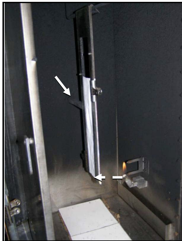
图 32. 放置固定在位的样本
