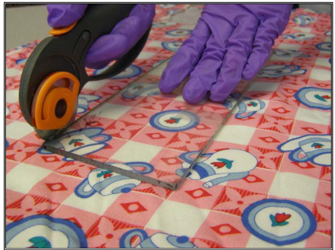
图 15. 使用模板制备面料样本
