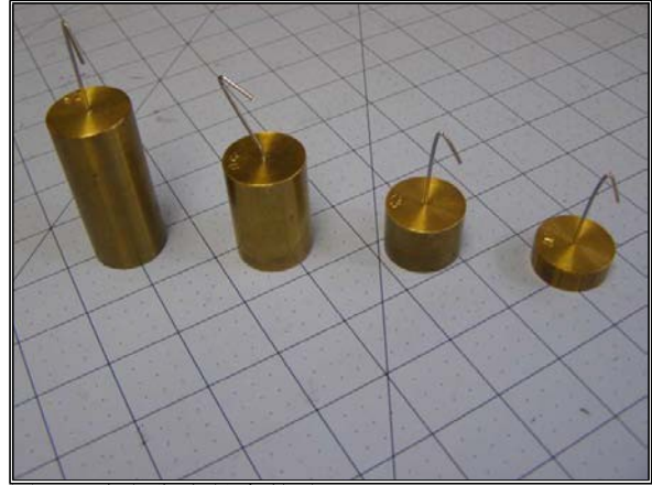
图 42. 确定焦痕长度的砝码
