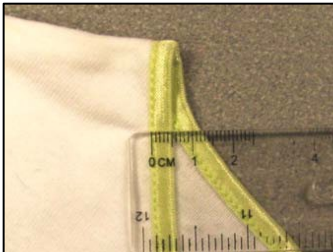
图 52. 从缝合点到松紧镶边边缘未超出 6 毫米
