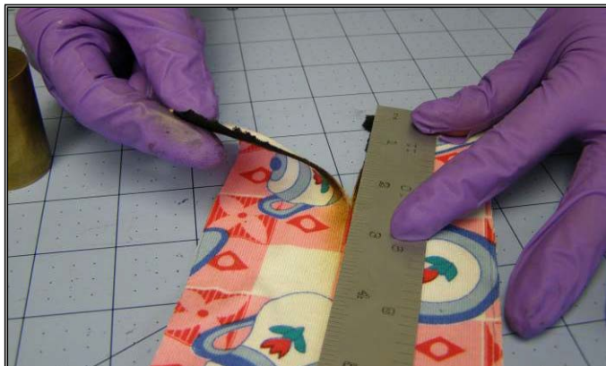
图 39. 测量焦痕长度
