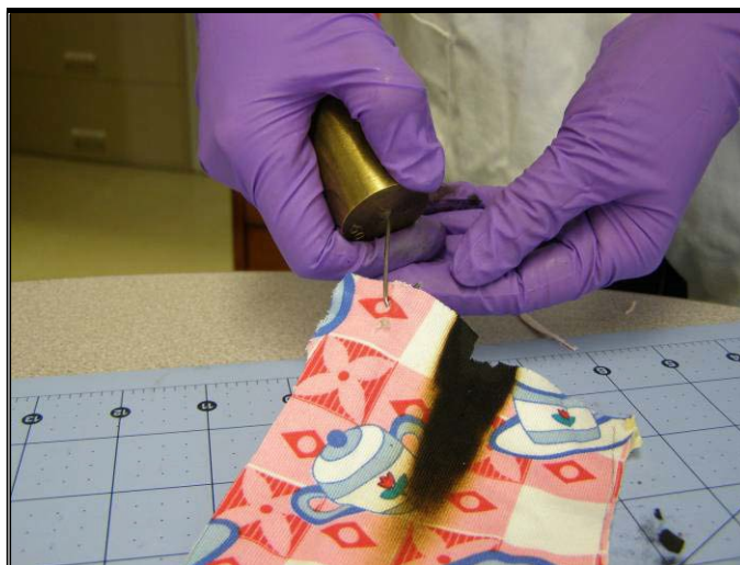
图 37. 将砝码挂在样本上
