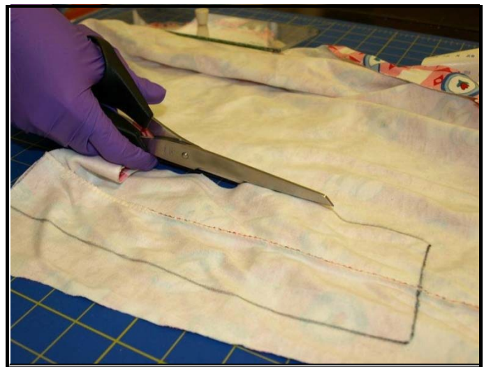
图 16. 制备接缝样本
