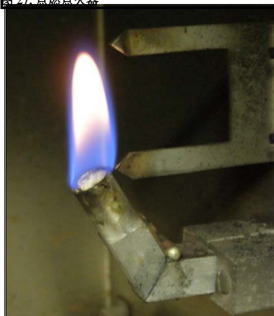
图 28. 检查火焰长度
