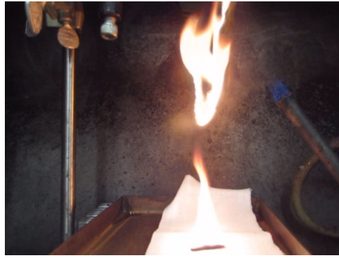
(d) Flaming dripping plastic
